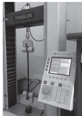
Hình 2. Thiết bị đo độ bền kéo đứt và độ giãn đứt Tensilon - Nhật Bản
